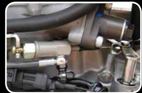
Ein kleiner Zylinder verrät: hier wird hydraulisch gekuppelt
