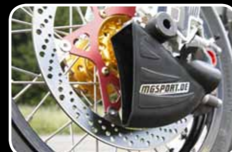
Ramair: die Bremsanlage wird durch den Fahrtwind gekühlt
