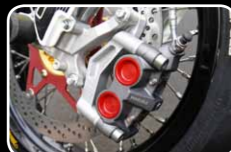
Mittels Adapter ist der Bremssattel am Gabelfuß montiert
